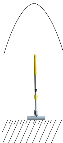
图9 峰值法探测示意图
