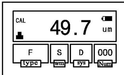
b) 先校零值。在选取的零点基体是，测量一次，按“**校零**”键，仪器系统归零。可连续重复进行多次，以获得一个多次校准的平均值，这样做可以提高校准的准确性；
