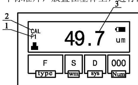
按“**↑**”“**↓**”键修正读数，使其达到标准片的标准值，然后按**确认**键，第一个校准值输入完毕，依次类推，输入完整 5 个试片的厚度，屏幕相应提示 P1 P2 P3 P4 P5。
