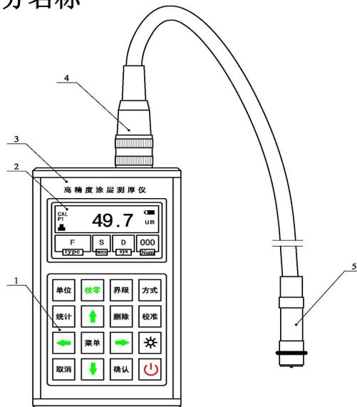
1.键盘 2.显示屏 3. 主机 4. 测头插座 5. 仪器测头
