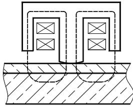
图 1-1 磁性法基本工作原理
