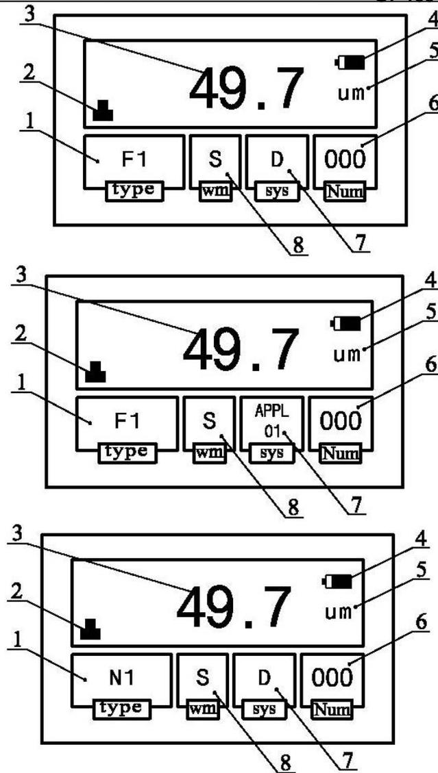
1. 测头类型指标 2 测量标志 3. 数据显示 4. 电池电量指示
