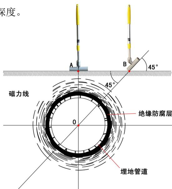
图10 管道45° 法测深图
