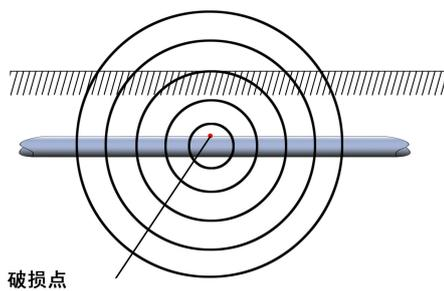
图11 地下破损点电位梯度立面分布图
