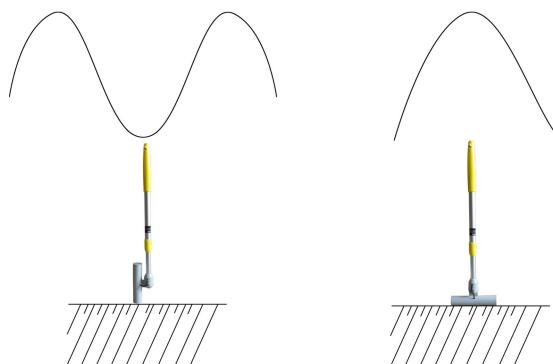
图8 零值法探测示意图
