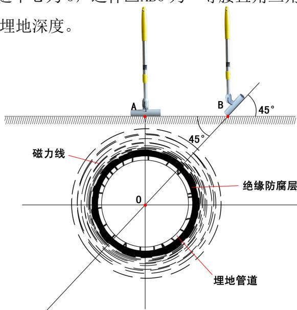
图10 管道 $45^{\circ}$  法测深图
