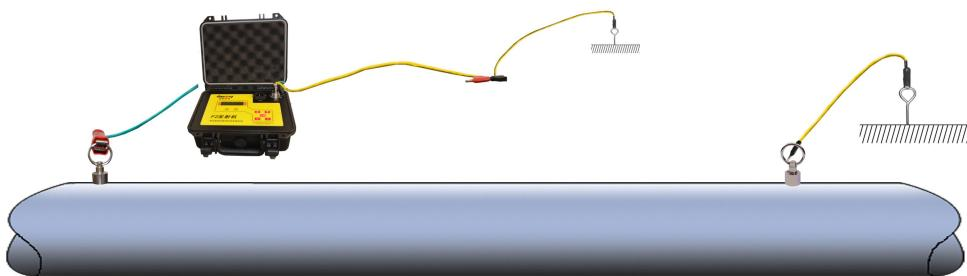
图7 远接地回路示意图
