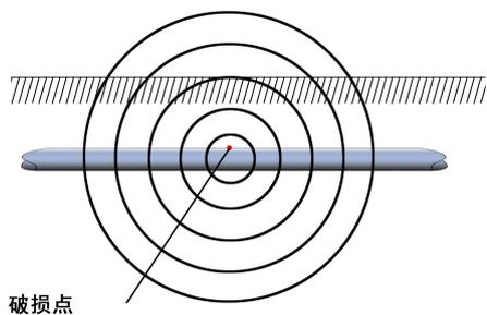
图11 地下破损点电位梯度立面分布图
