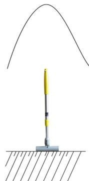
图9 峰值法探测示意图
