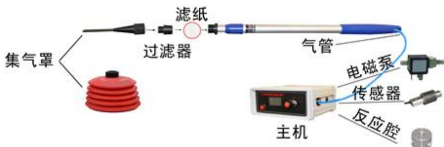
当气路发生堵塞时，延时 5 秒后，堵塞如果没有解除，保护电路会将电磁泵关闭，显示 F—1，蜂鸣器直响。30 秒后电磁泵会自动打开，系统循环检测。请关闭电源检查气路的连接是否有异物堵塞。
