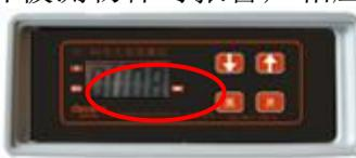
8、按下高压枪按钮的同时，按下主机上的↑键，主机显示高压枪的输出高压值，松开高压枪的按钮，主机会恢复到电源的电压值，此时按下关键机器关机（显示器正常计数到 99），若需要计数数值清零，请重新开机。
