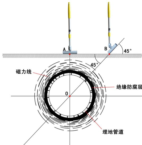
图10 管道 $45^\circ$  法测深图
