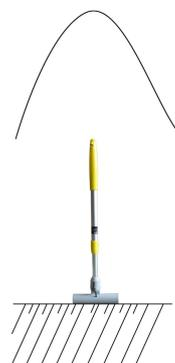
图9 峰值法探测示意图
